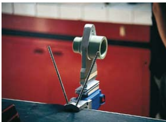
Photo 1: Appareil pour la soudure manuelle des tubes et des raccords à souder dans l'emboîture
